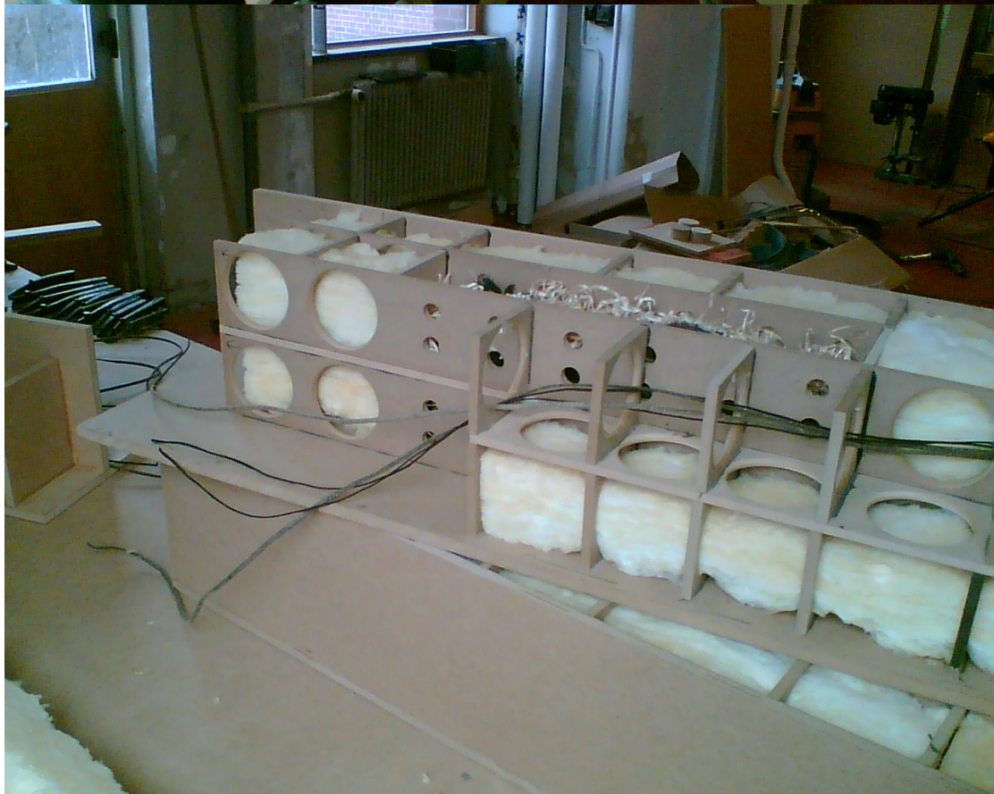
Kabelføringen til enhederne. (Toppen af kabinettet ser længere ud end meningen, dette er en fejl, som senere bliver skåret væk)
